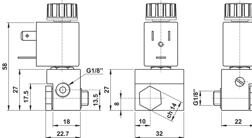
Questo elettropilota può essere montato direttamente su cilindri a semplice o doppio effetto o su valvole per controllo fluidi a comando pneumatico. È orientabile su 360° grazie al serraggio mediante vite cava.
